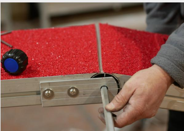
**17** Une fois le trou de la plaque positionné en face du trou de la charnière, vous pouvez insérer la tige de fixation dans l'axe
