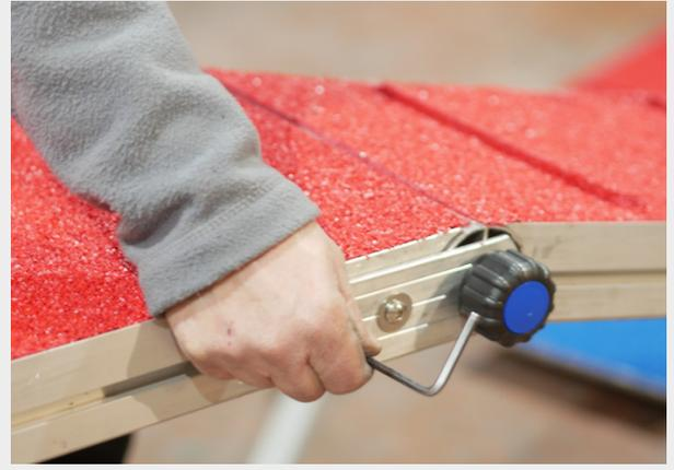
**16** Vous pouvez à présent dévisser les deux vis qui permettent de faire coulisser la plaque, jusqu'à ce que le trou situé sur l'extrémité de la plaque soit en face du trou de la charnière
